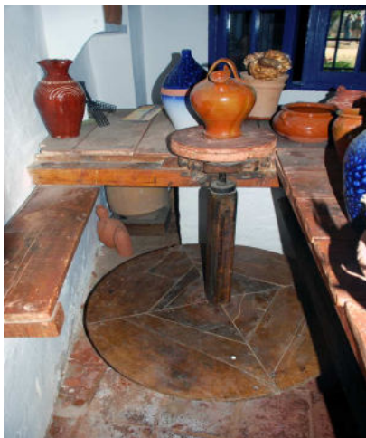
Fig. 5d. Torno de doble rueda del Alfar en Consuegra (Toledo) y componentes del torno de pie paquistaní (Rye y Evan, 1976).
