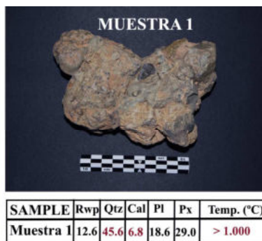
Fig. 11c. Recreación de una villa romana pars rustica/frumentaria (MAR) y restos de la escoria de arcilla analizada (Muestra 1), procedente de la villa de La Ermita de La Magdalena (Consuegra). La composición mineralógica de la muestra analizada y la temperatura estimada demuestran que se trata de una escoria de arcilla (J. M. Compañía Prieto, 2015).
